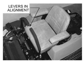
FIGURE 5 LEVER ALIGNMENT
